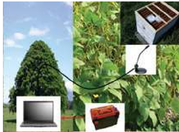
Figura 2. Montaje para adquisición de señales de audio en colmenas. Se colocó un micrófono de PC dentro de la colmena en un entrepiso técnico para evitar que las abejas lo cubran con cera. Aproximadamente a 50 m se encuentra un computador portátil alimentado a baterías que permite la grabación y almacenamiento de las señales.
